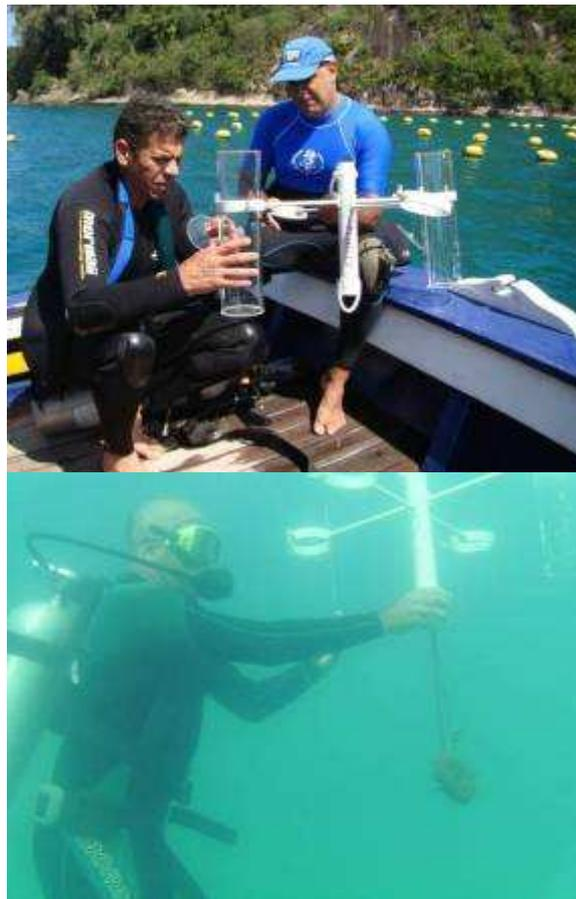
Figura 14 Dispositivo instalado pela UERJ para verificar taxa de sedimentação em cultivo na Praia da Conceição
