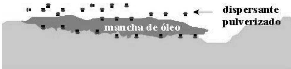
2. Óleo disperso em gotículas estabilizada pelo surfactante
