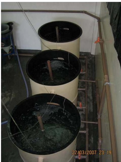
Figura 24: Tanques de cultivo com 590l, desenvolvidos especificamente para este projeto, com revestimento interno, bordas escuras, base cônica e escoamento de água superficial.
