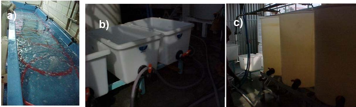
Figura 19: Tanques de cultivos testados para definição do modelo a ser utilizado: a) calha; b) tanque retangulares e; c) tanques circular.
