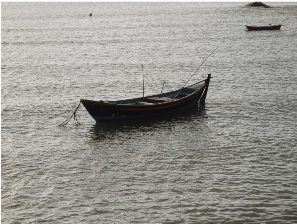
Embarcação de fundo chato, a Bateira permiteo traslado em baixas profundidades.
